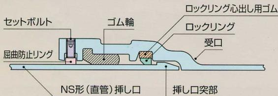
本図は呼び径 200 の標準寸法図です。他の呼び径は形状が若干異なります。
